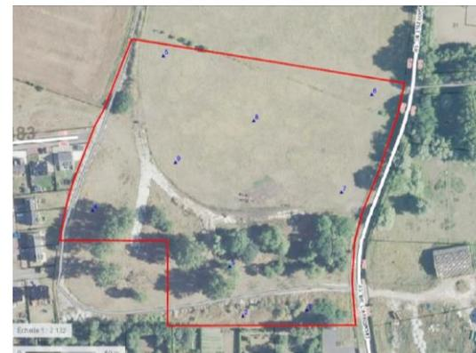
Figure 43 - Plan d'implantation des différents sondages pédologiques réalisées (URBYCOM)
