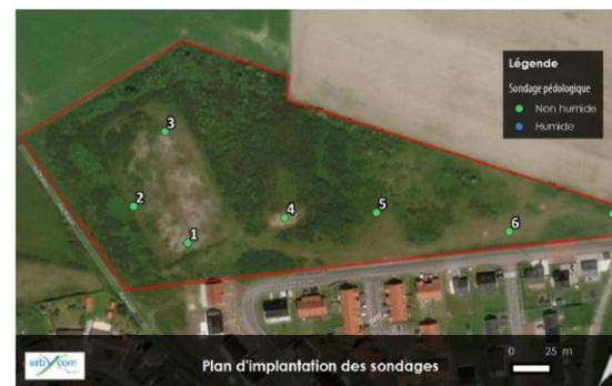
Figure 44 - Plan d'implantation des différents sondages pédologiques réalisées (URBYCOM)
